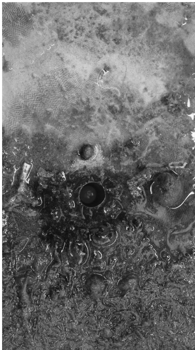
Рис. 3. Полированный образец, верхняя часть которого покрыта супергидрофобным слоем, через 55 дней испытаний в морской воде.
