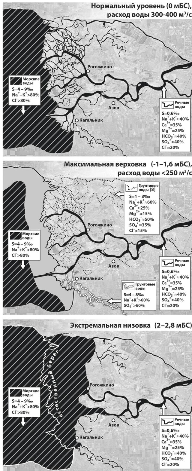
Рис. 5. Изменение питания и ионного состава дельты Дона при разных уровнях воды.
