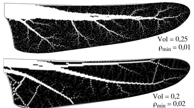
Рис. 8. Топология крыла стрекозы, оптимизированного SIMP-методом
