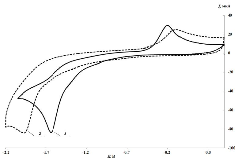
Рис. 3.10. ЦВА-кривая восстановления трисульфидов: 1 –  $(C_6H_5)_2S_3$ ; 2 –  $(C_4H_9)_2S_3$  ( $CH_3CN$ , 0,15 М  $n-Bu_4NClO_4$ ,  $C = 3$  ммоль·л<sup>-1</sup>,  $v = 0,2$  В·с<sup>-1</sup>, СУ-анод,  $Ag/AgCl/KCl$ )
