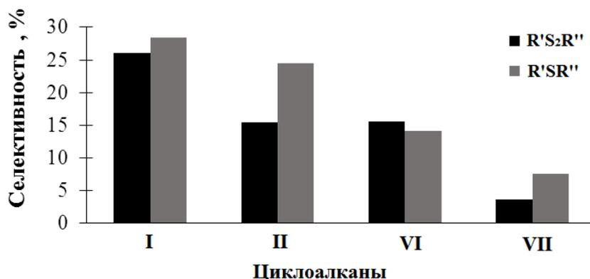
Рис. 3.8. Зависимость селективности реакций образования асимметричных моно- и дисульфидов при взаимодействии  $\text{H}_2\text{S}$  и ди(*трет*-бутил)дисульфида с циклоалканами  $\text{C}_5\text{-C}_8$  от размера алицикла
