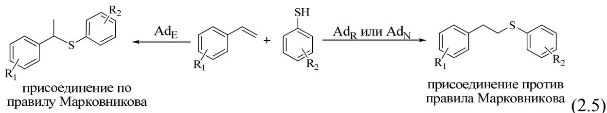
Реакция радикального присоединения протекают с участием тиольного радикала, который образуется в условиях фотоактивации или в присутствии катализатора. Взаимодействие  $RS^\bullet$  с алкеном по  $C=C$ -связи сопровождается образованием сероцентрированного радикала, который отщепляет от второй молекулы тиола водород и образует целевой несимметричный сульфид, а также новый тиольный радикал, способный к дальнейшим превращениям (схема 2.6) [9].
