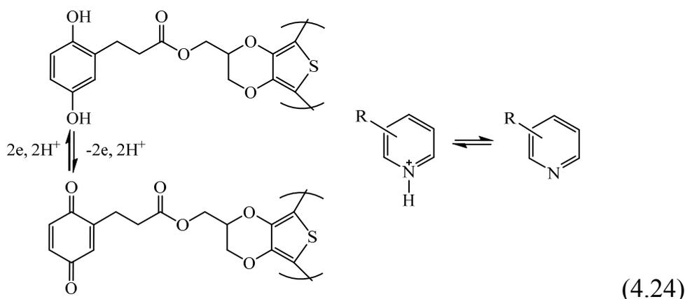
Двехиноновые группы, объединенные редокс-полимером, были использованы в качестве положительного и отрицательного электродных материалов при сборке протонной батареи с использованием полужидкой смеси органических кислот и оснований в качестве электролита, обладающего свойствами ионной жидкости [55].
