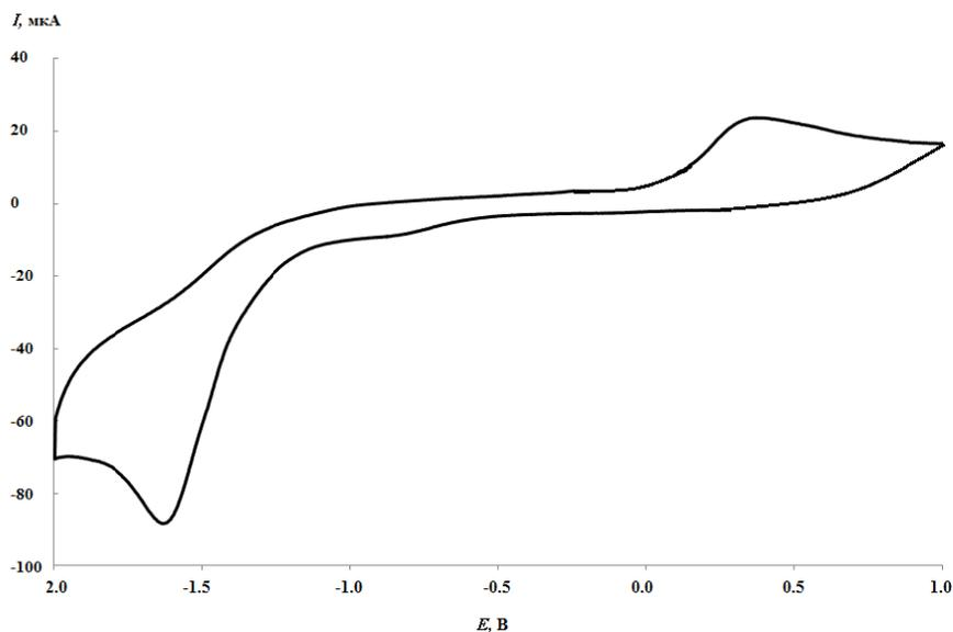
Рис. 3.11. ЦВА-кривая восстановления  $(C_6H_5)_2S_3$  в присутствии  $CH_3COOH$  ( $CH_3CN$ ,  $0,15 M n-Bu_4NClO_4$ ,  $C = 3 \text{ ммоль} \cdot \text{л}^{-1}$ ,  $v = 0,2 \text{ В} \cdot \text{с}^{-1}$ , СУ-анод,  $Ag/AgCl/KCl$ )
