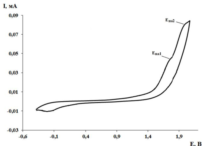
Рис. 3.1. ЦВА-кривая окисления продуктов электролиза (1ч) системы сероводород-сера (1:1) с циклогексаном ( $\text{CH}_2\text{Cl}_2$ , Pt-анод,  $E = 1,90 \text{ В}$ ,  $0,15 \text{ моль}\cdot\text{л}^{-1} \text{Bu}_4\text{NClO}_4$ ,  $\text{Ag}/\text{AgCl}/\text{KCl}$ ,  $C(\text{H}_2\text{S}) = C(\text{S}_8) = 5,0 \text{ ммоль}\cdot\text{л}^{-1}$ ,  $C(\text{C}_6\text{H}_{12}) = 0,3 \text{ моль}\cdot\text{л}^{-1}$ )
