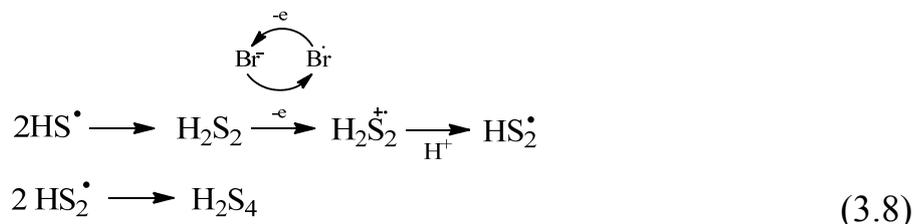
При длительном проведении реакции повышается концентрация полисульфанов с высокой молекулярной массой  $H_2S_n$  ( $n \geq 4-8$ ), которые превращаются в  $S_8$  [45, 46].
