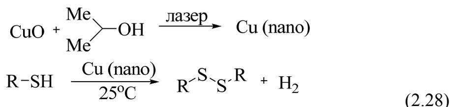
Медь, осажденная при восстановлении с использованием боргидридных ионообменных смол (BER), также может быть использована для реакции окисления тиолов до дисульфидов (схема 2.29) [32].
