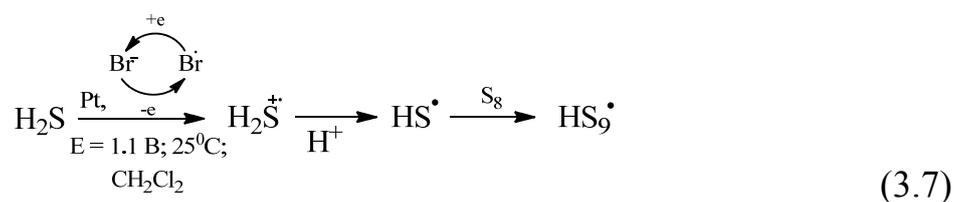
Димеризация тиильных радикалов как продуктов фрагментации нестабильного катион-радикала  $H_2S$  приводит к образованию неорганических полисульфанов ( $H_2S_n$ ) с различным содержанием атомов серы. Электролиз при потенциале окисления медиатора благоприятствует одноэлектронному окислению  $H_2S_n$  (0,4–1,5 В) до  $HS_n$ -радикалов (схема 3.8).
