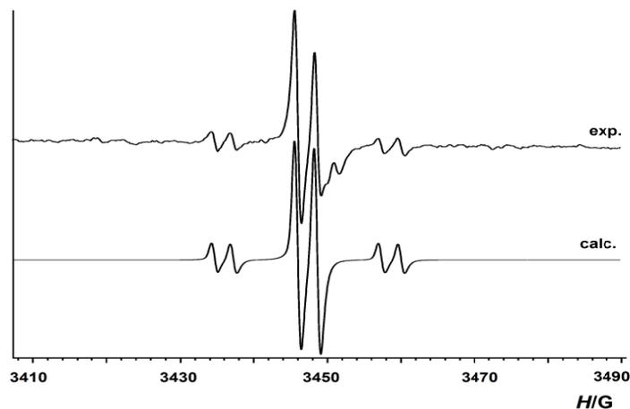
Рис. 4.6. Спектр ЭПР системы «11 + PbO<sub>2</sub>» в толуоле при нагревании при 60 °С в течение 30 минут
