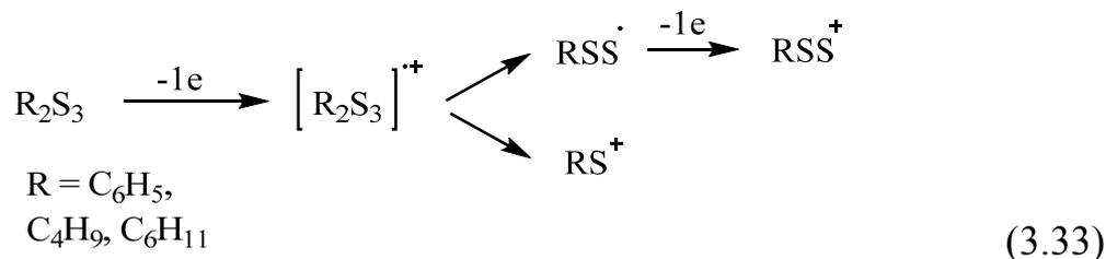
Подобное поведение  $R_2S_3$  в условиях анодной активации позволяет рассматривать симметричные трисульфиды 1-3 в качестве источника двух видов электрофильных частиц ( $RS^+$  и  $RSS^+$ ). Электроокисление несимметричного трисульфида 4 в аналогичных, условиях приводит к смеси электрофильных частиц ( $CH_3S^+$ ,  $C_3H_7S_2^+$ ,  $CH_3S_2^+$ ,  $C_3H_7S^+$ ). На вольтамперограммах окисления продуктов микроэлектролиза трисульфидов ( $E = 1,85$  В,  $\tau = 2$  ч)
