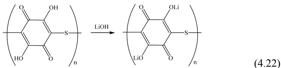
Серосодержащие гетероциклические хиноны (схема 4.23) широко используются как катоды в комбинации с проводящим полимером на основе тиофена, выступающего в роли многофункционального связующего для перезаряжаемых литий-ионных батарей [54].
