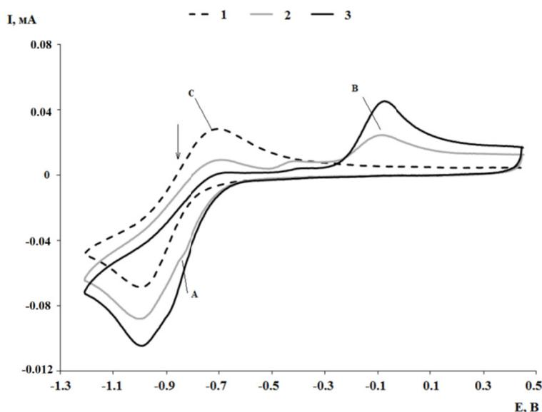
Рис. 4.3. ЦВА-кривые восстановления кислорода при различных концентрациях соединения 4: кривая 1 ( $0 \text{ ммоль} \cdot \text{л}^{-1}$ ); кривая 2 ( $2 \text{ ммоль} \cdot \text{л}^{-1}$ ), кривая 3 ( $4 \text{ ммоль} \cdot \text{л}^{-1}$ ) (при развертке потенциала от  $+0,5$  до  $-1,20 \text{ В}$ ) ( $\text{CH}_3\text{CN}$ ,  $\text{Cu}$ -электрод,  $\text{Ag}/\text{AgCl}/\text{KCl}$ ,  $0,1 \text{ MNBu}_4\text{ClO}_4$ ,  $\nu = 0,2 \text{ В} \cdot \text{с}^{-1}$ )
