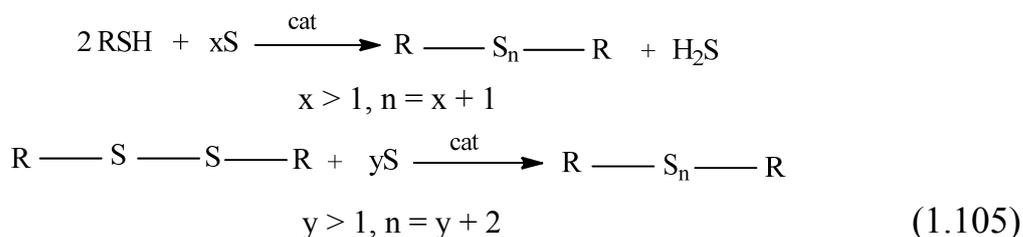
Выход образующихся соединений составляет 85,3 %, а содержание серы в них достигает 63,9 % (об.). Синтезированные продукты реакции являются экологически безопасными и используются в процессе сульфуризации катализаторов гидрирования.
