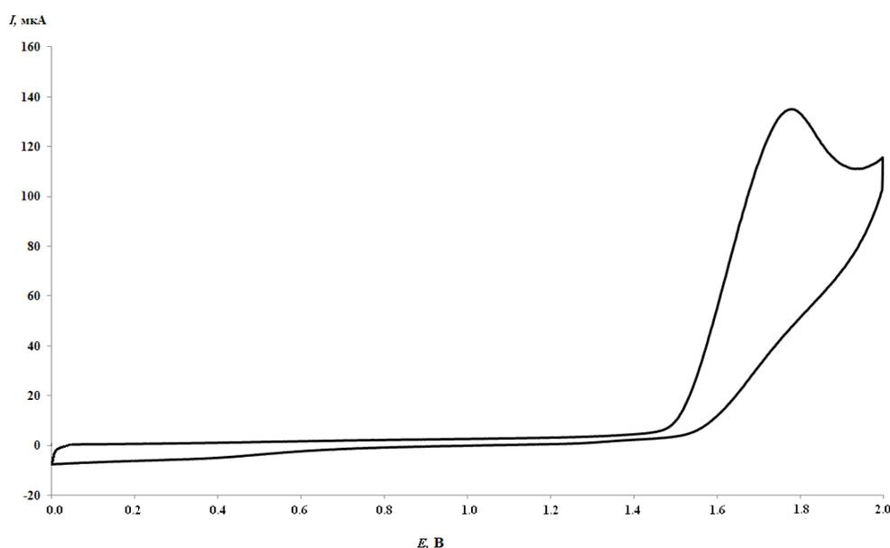
Рис. 3.9. ЦВА-кривая окисления  $(C_6H_5)_2S_3$
