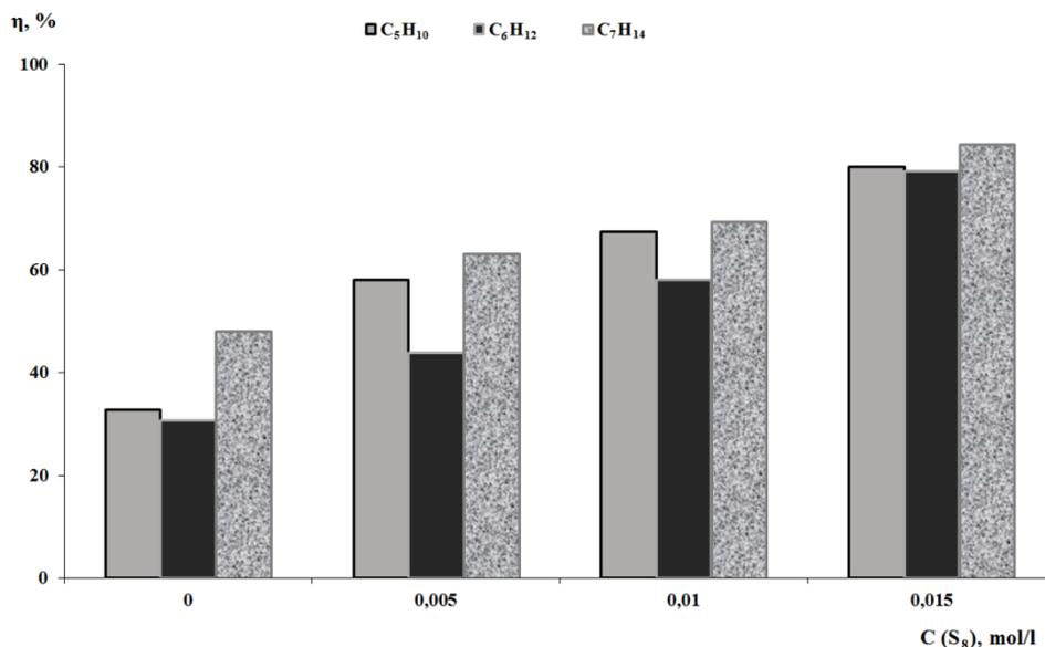
Рис. 3.3. Зависимость общего выхода полисульфидов ( $\eta$ , %) от концентрации серы в реакциях  $C_5$ - $C_7$  с сероводородом  $H_2S$  (1:3) в присутствии медиатора ( $C(n-Bu_4NBr) = 5$  ммоль,  $\tau = 90$  мин,  $E_{па} = 1,1$  В, Pt-анод,  $CH_2Cl_2$ )
