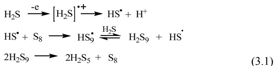
Следует отметить, что увеличение концентрации  $\text{S}_8$  в реакционной смеси с сероводородом приводит к преобладанию в растворе гидрополисульфидных радикалов.
