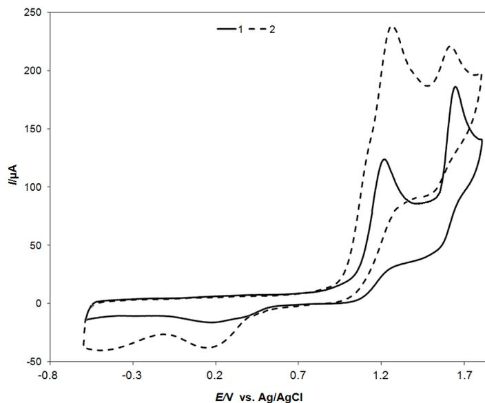
Рис. 4.5. ЦВА окисления тиоэфиров 9 (кривая 1) и 11 (кривая 2) – в диапазоне развертки потенциала от  $-0,6$  до  $+1,8$  В ( $\text{CH}_3\text{CN}$ , СУ-анод,  $\text{Ag}/\text{AgCl}/\text{KCl}$ ,  $0,1\text{MNBu}_4\text{ClO}_4$ ,  $C = 3 \text{ ммоль}\cdot\text{л}^{-1}$ ,  $\nu = 0,2 \text{ В}\cdot\text{с}^{-1}$ , аргон)
