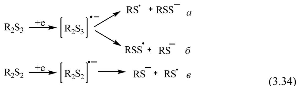
На обратной ветви ЦВА-кривой восстановления трисульфидов 1-4 фиксируется пик окисления  $E'_{\text{па}}$  в диапазоне значений  $-0,22 \dots -0,11$  В, отвечающий продукту распада анион-радикала. Помимо генерирования на катоде сероцентрированных анионов одновременно происходит процесс образования радикальных частиц ( $RS^\bullet$  или  $RS_2^\bullet$ ), способных к димеризации до  $R_2S_2$  и  $R_2S_4$ .
