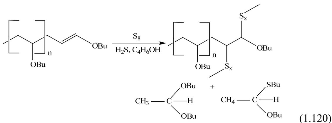
Полученные серосодержащие полимеры на основе олиго-*n*-бутилвинилового эфира и элементарной серы обладают высоким технологическим потенциалом и разнообразными физико-химическими свойствами.
