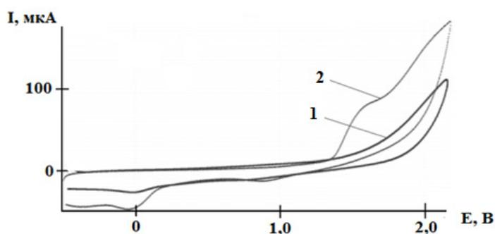
Рис. 3.6. ЦВА окисления: 1 – *n*-Bu<sub>4</sub>NClO<sub>4</sub> (C = 0,015 моль·л<sup>-1</sup>), 2 – (*n*-C<sub>4</sub>H<sub>9</sub>)<sub>2</sub>S<sub>2</sub> (C = 0,005 моль·л<sup>-1</sup>) (CH<sub>2</sub>Cl<sub>2</sub>, Pt-анод, Ag/AgCl, ν = 0,2 В·с<sup>-1</sup>)
