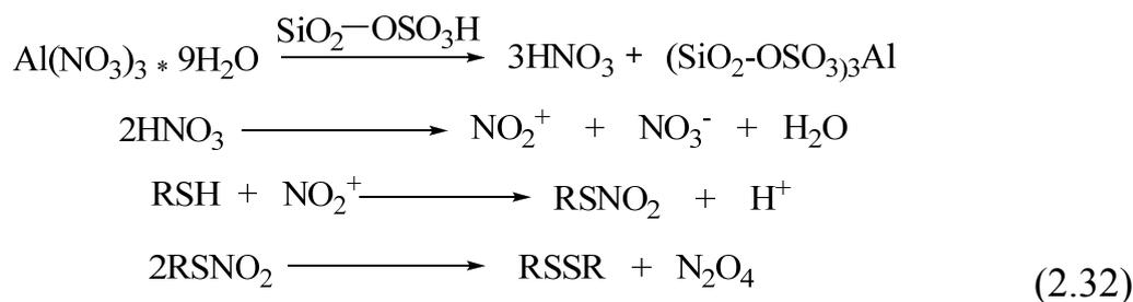
В синтезе дисульфидов с длинной боковой цепью одним из известных окислителей тиолов является йод. Например, натриевая соль тиосульфоновой кислоты и S-алкильный эфир (соль Бунте) при обработке йодом образуют дигексадецил дисульфид [36]. Несимметричный дисульфид 11-(12-йоддодецилдисульфанил)-ундека-1-ол может быть успешно синтезирован в этаноле при смешивании  $\text{I}_2$  с 12-йод-додекан-1-тиолом и 11-меркапто-1-ундекаолом (схема 2.33) [37].
