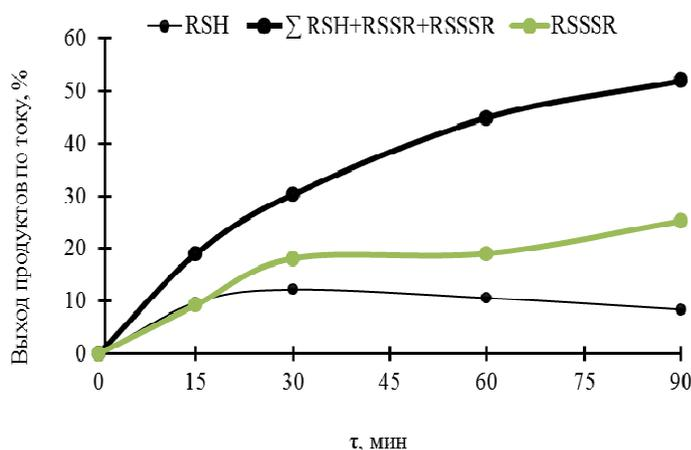
Рис. 3.4. Зависимость выхода серосодержащих соединений, полученных при взаимодействии сероводорода с циклогептаном при использовании комплекса хрома(III), от времени
