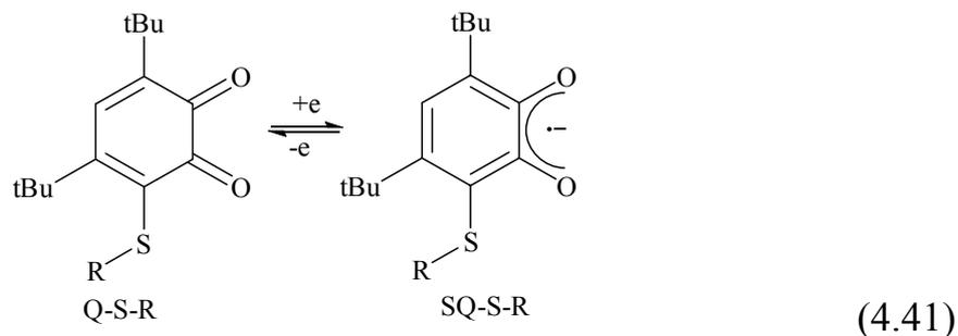
В ИК-спектрах продуктов электролиза наблюдаются полосы, отвечающие валентным колебаниям связей C=O в *o*-хинонах (1 740 и 1 640–1 670 см<sup>-1</sup>). В УФ-видимом спектре поглощения продуктов электролиза регистрируется интенсивный максимум поглощения в диапазоне 500–510 нм (рис. 4.2).
