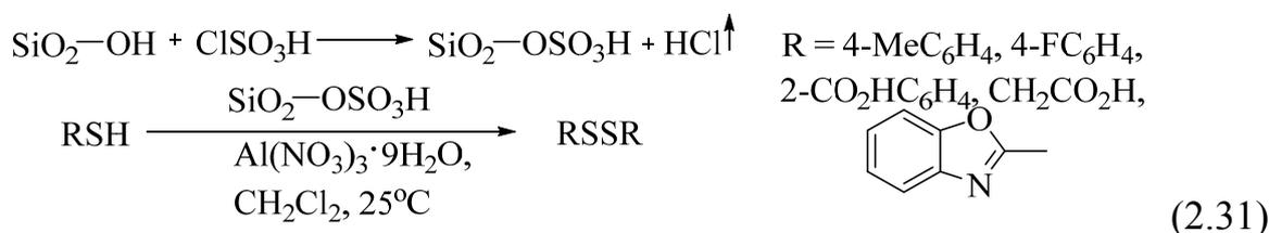
Особенностями используемого катализатора являются высокие выходы целевых дисульфидов (99 %) и отсутствие побочных продуктов сочетания. Предполагаемый механизм включает генерирование азотной кислоты из нитрата алюминия при воздействии КСК с последующим разложением азотной кислоты до катиона  $\text{NO}_2^+$ , который реагирует с тиолом (схема 2.32).
