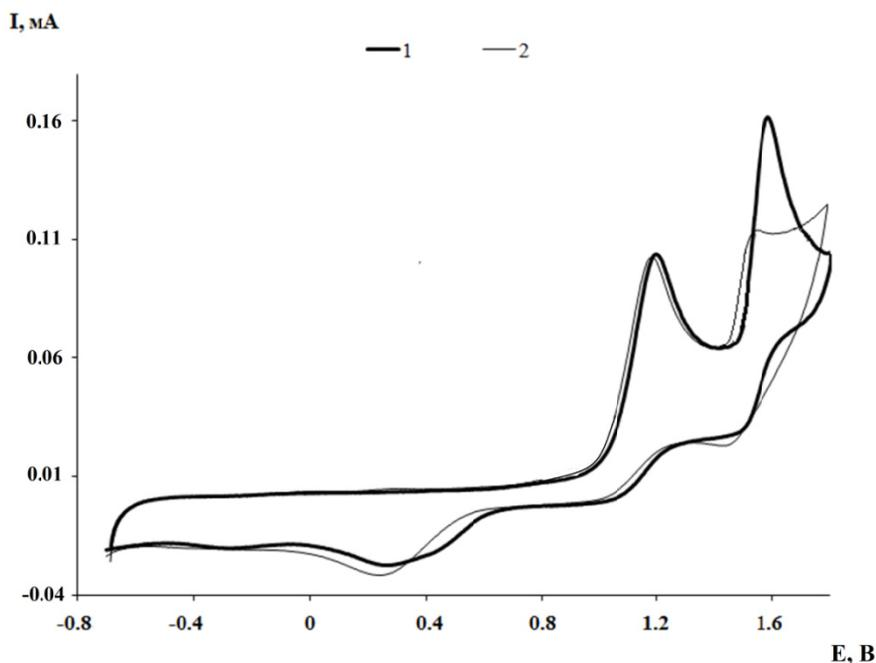
Рис. 4.1. ЦВА окисления тиоэфиров 4 (кривая 1) и 8 (кривая 2) – в диапазоне развертки потенциала от  $-0,7$  до  $+1,8$  В ( $\text{CH}_3\text{CN}$ , СУ-анод,  $\text{Ag}/\text{AgCl}/\text{KCl}$ ,  $0,1$  М  $\text{NBu}_4\text{ClO}_4$ ,  $C = 3$  ммоль·л $^{-1}$ ,  $v = 0,2$  В·с $^{-1}$ , аргон)
