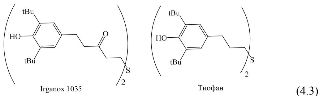
Модификация подобного рода полифункциональных соединений может происходить по нескольким направлениям: наращивание полисульфидной цепи, получение несимметричных тиоэфиров, варьирование углеводородных групп в фенольном фрагменте, изменение состояния окисления атома серы, замена атома серы на селен. Обнаружено, что ди- и трисульфиды, содержащие фенольные фрагменты, являются эффективными ингибиторами аутоокисления липидов [13] (схема 4.4).
