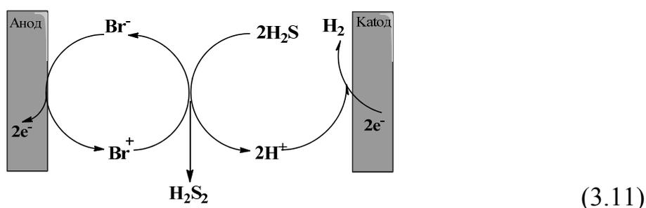
В условиях двухэлектронного окисления бромид-аниона при взаимодействии с  $H_2S$  предположительно генерируется сероцентрированный катион ( $HS_2^+$ ), который реагирует с бензолом до промежуточного продукта – гидрофенилдисульфана (схема 3.12).
