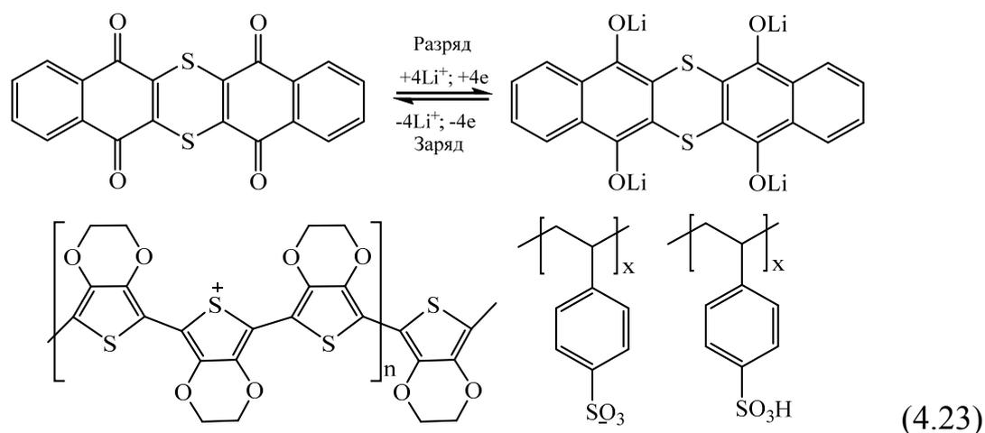
Сочетание редокс-активного хинонового фрагмента с серосодержащим проводящим редокс-полимером позволило получить полностью органическую батарею (схема 4.24).
