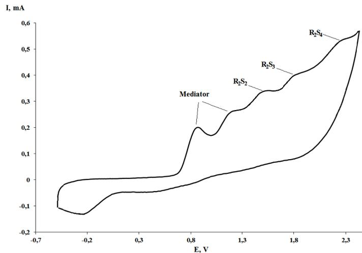
Рис. 3.2. ЦВА-кривая смеси продуктов электролиза циклопентана с сероводородом и серой в присутствии медиатора ( $C(n\text{-Bu}_4\text{NBr}) = 5$  ммоль,  $\tau = 90$  мин,  $E = 1,1$  В, Pt-анод,  $\text{CH}_2\text{Cl}_2$ )
