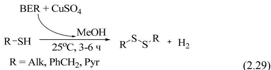
Установлено, что Cu-катализатор, приготовленный с использованием NaBH<sub>4</sub> с силикагелем и без него, а также медь, измельченная до порошка, проявляют гораздо меньшую эффективность по сравнению с системой BER-CuSO<sub>4</sub>. В присутствии стирола при использовании данного катализатора диспропорционирование гексантиола ведет к образованию только соответствующего дисульфида.
