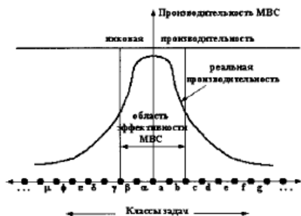
Рис. 1. Зависимость производительности многопроцессорной вычислительной системы (суперкомпьютера) от класса задач
