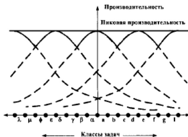
Рис. 2. Приближение реальной производительности МВС к пиковой за счет программирования и перестройки архитектуры
