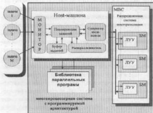
Рис. 5. Структура распределенной операционной системы суперЭВМ
