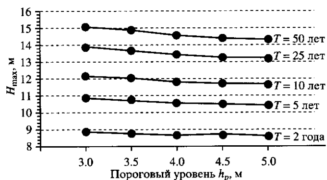
Рис. 2. Оценка максимальной высоты волны, возможной один раз в T лет, при разных пороговых уровнях. Экспоненциальное распределение
