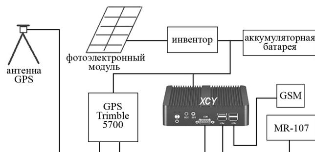
**Рис. 4.** Схема аппаратного комплекса СГП Порт-Кавказ.
