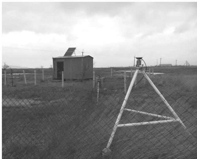
**Рис. 3.** Приемное антенное устройство и фотоэлектрический модуль на крыше вагончика с аппаратурой СГП Порт-Кавказ.
