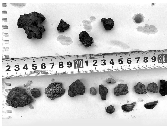
Рис. 4. Размеры частиц угольного шлака из колонки донных отложений (гирло Свиное) (по: [1; 11]).
