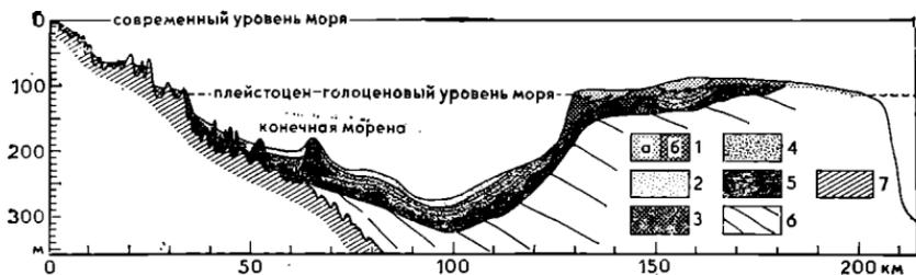
Рис. 9. Геологический разрез шельфа в районе Новой Шотландии, составленный по материалам сейсмопрофилирования, морского бурения и отбора грунтовых колонок (King, 1979).
