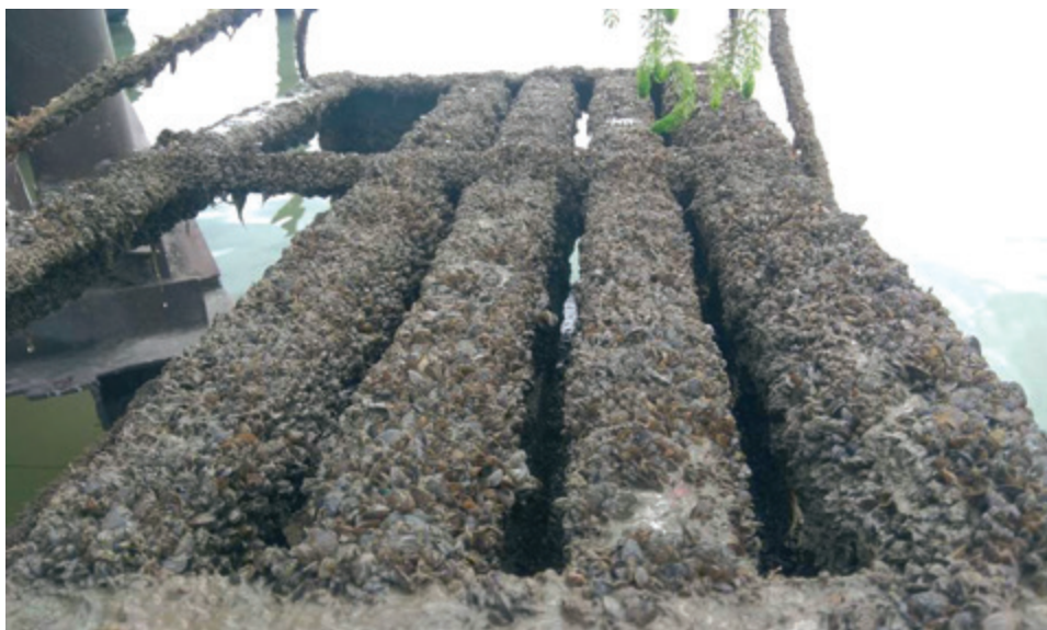
Рис. 5.16. Обрастание деревянной поверхности стенда, сформировавшееся за 9 месяцев экспозиции у ГМП «Донской»
