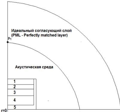
Рисунок 4 — Схема многослойного преобразователя в акустической среде: 1 – акустическое окно, 2 – согласующий слой, 3 – активный слой из пористой пьезокерамики, 4 – подложка, 5 – защитный слой
