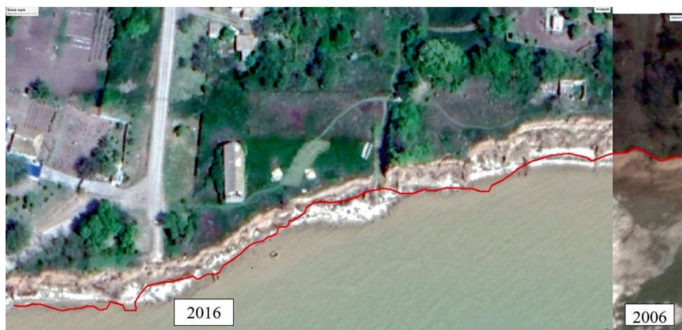
Рис. 1. Абразивные процессы на побережье Таганрогского залива (сравнение снимков 2006 и 2016 гг.). Красная линия – состояние берега по данным 2006 г.
