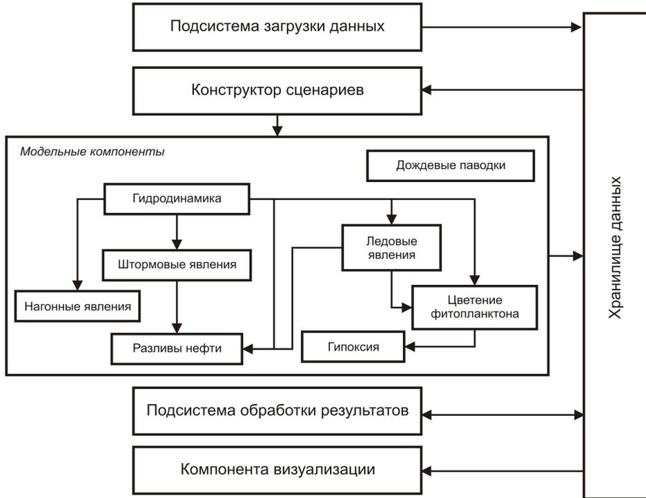
Рис. 1. Обобщенная архитектура ПК “EX-MARE”
