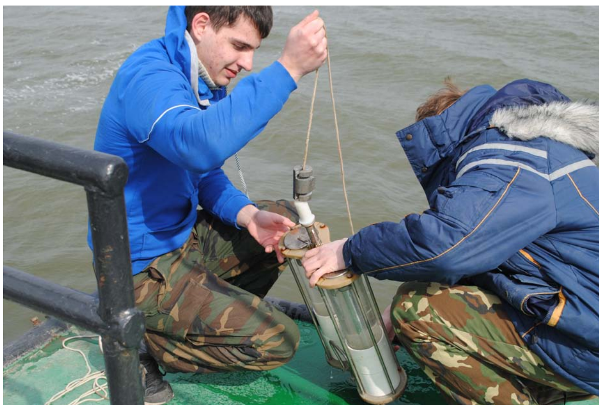
Отбор проб морской воды с помощью батометра Молчанова
