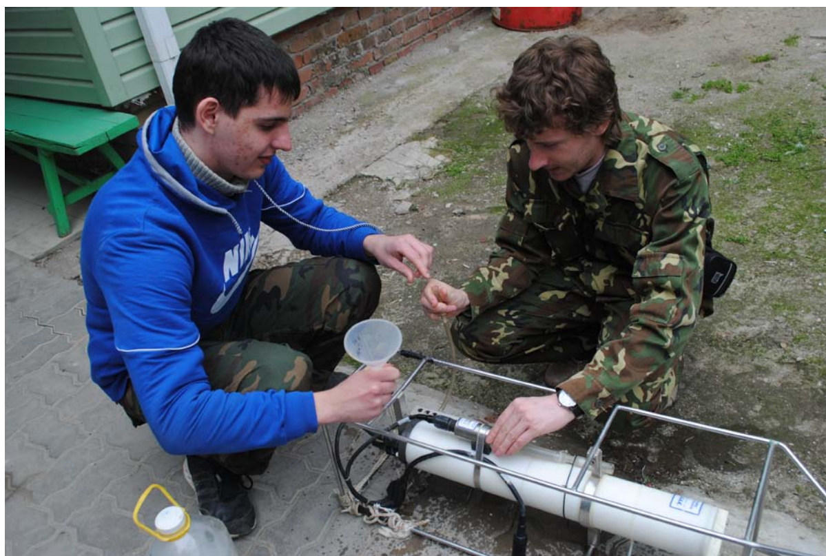
Промывка датчиков зонда дистиллированной водой после работы в море
