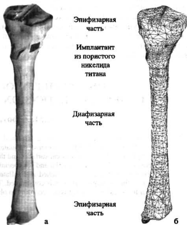
Рис. 1. Большеберцовая кость: а – трехмерная модель; б – конечно-элементная сетка
