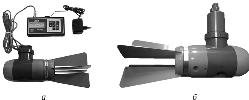
Рис. 1. Акустический измеритель скорости течения, температуры и давления: переносной вариант (а), автономный вариант (б)
