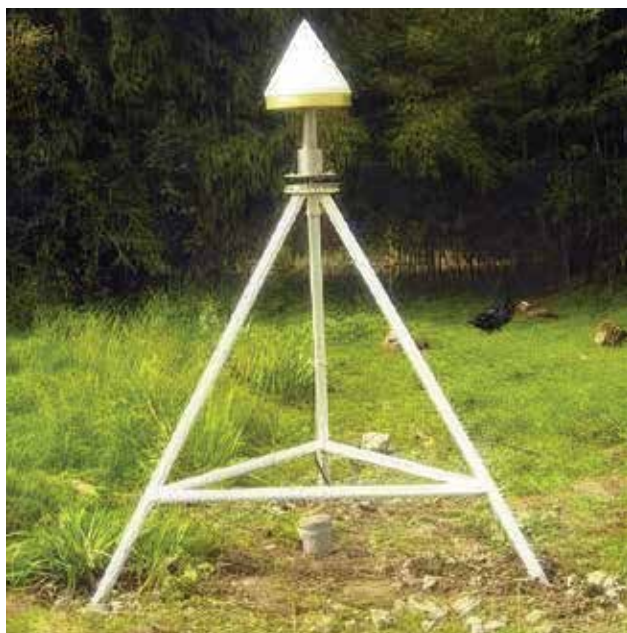
Рис. 27. Спутниковая GPS/ГЛОНАСС-антенна станции «Адлер»
