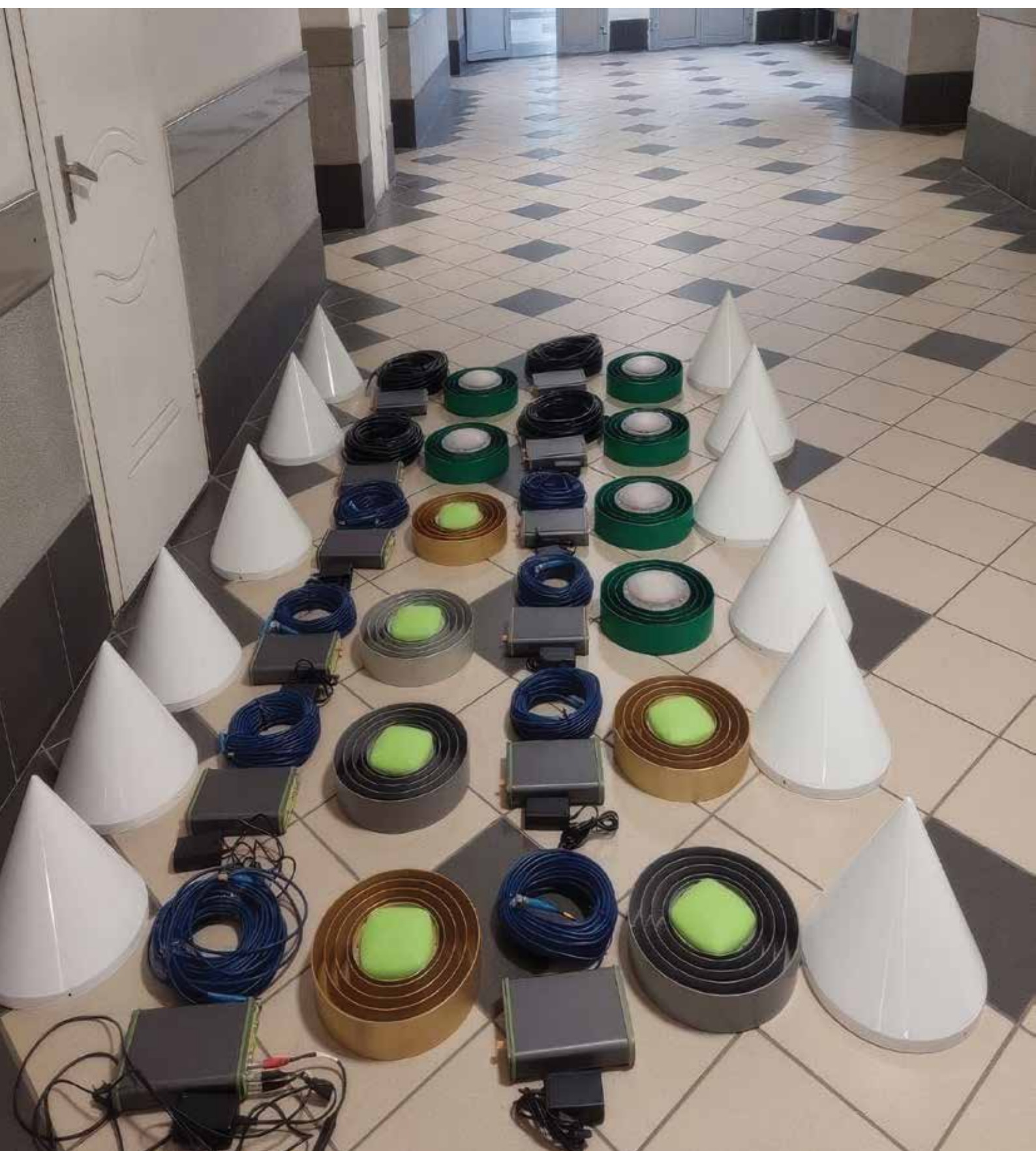
Рис. 5. Мобильные средства исследования. Двенадцать мобильных GPS-приемников, готовых для установки на треноги для работы
