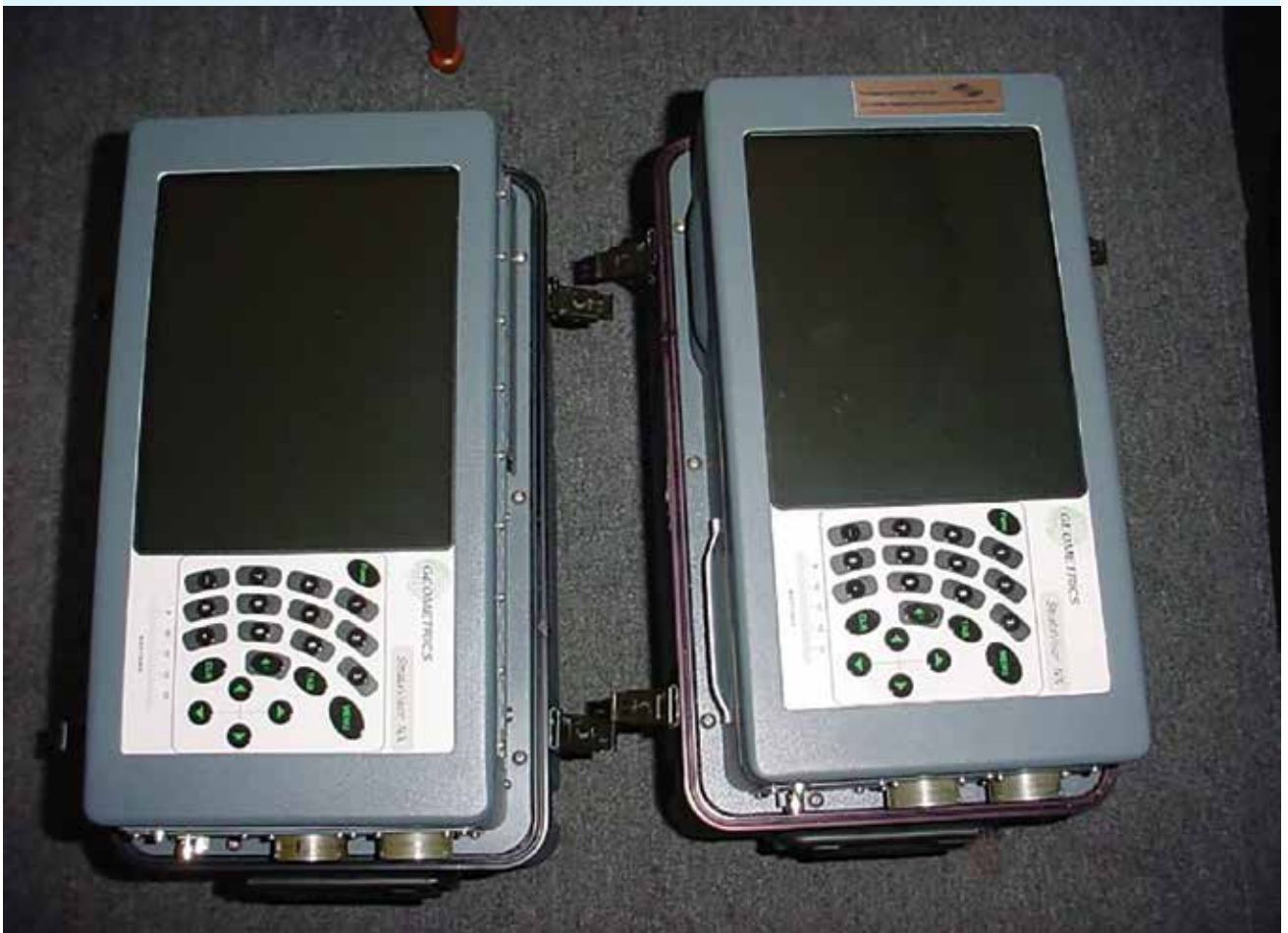
Рис. 10. Портативные средства обработки геофизической информации, поступающей от действия вибросейсмоисточников "Geometrics"
