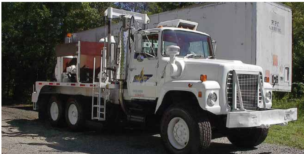
Рис. 6а. Вибросейсмоисточник А-1100 мощностью 20 тонн
