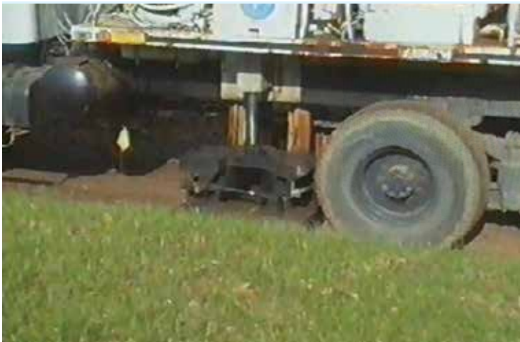
Рис. 9. Полигон КубГУ. Процесс вибрационного воздействия сейсмоисточника на грунт с целью возбуждения сейсмических волн для просвечивания Земли
