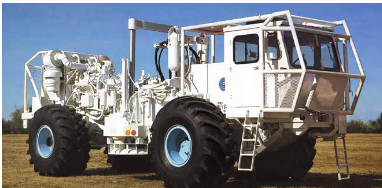
Рис. 6б. Вибросейсмоисточник Y-3000 мощностью 30 тонн
