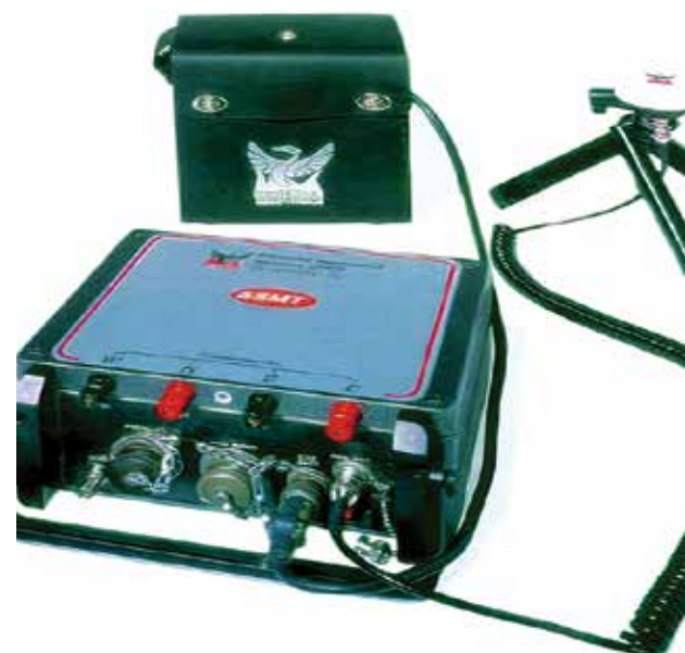
Рис. 11. Станция магнитотеллурического исследования глубинного строения Земли
